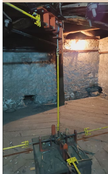
Převod z hodinového stroje na 3 ciferníky
